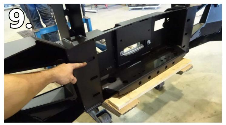
MOUNT BUMPER USING THE **5/8**" **x 2**" BOLTS PROVIDED. ADJUST THE BUMPER SO THE TOP SURFACE HAS AN EVEN GAP ALONG THE TOP.
