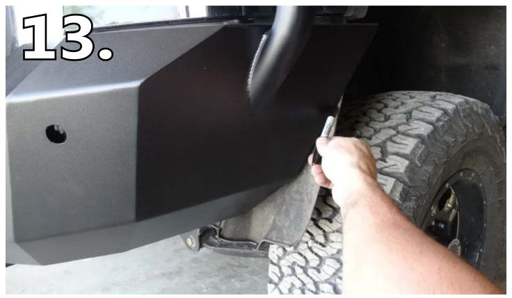
ONCE THE BUMPER HAS BEEN PROPERLY ALIGNED, MARK THE INNDER FENDER WELL ON EACH SIDE. THEN CUT OFF SO THAT THE FENDER MATCHES UP TO THE BUMPER!
